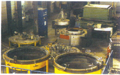
Bild 2. Prozessgesteuerter Schachtofenkomplex 1500 x 2000 zum Gasnitrieren und -nitrocarburieren in der Härtereie Reese Weimar
