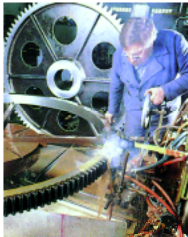
6: Induktives Härten von Zahnflanken und Zahngrund Quelle: Härterei Bochum
