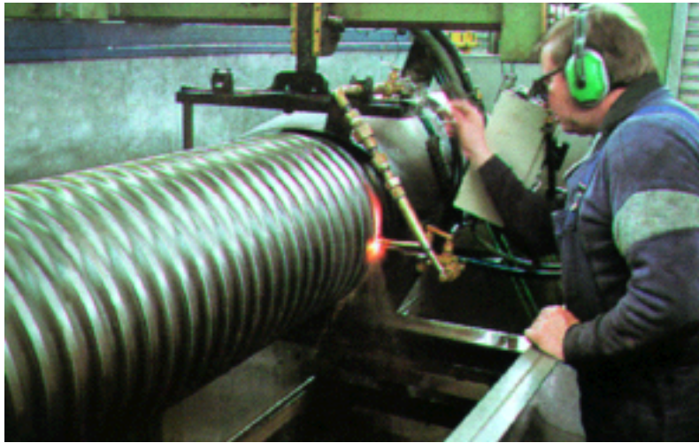
2:Randschichthärtung durch Flammerwärmung
