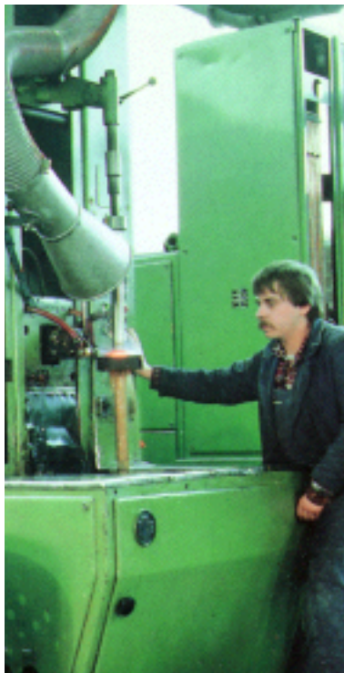
5: Induktivhärtung einer Welle Quelle: Härterei Bochum
