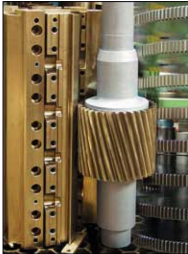
Werkstücke vor dem Gasnitrieren, grüne und graue Bereiche mit Nitrierschutz
