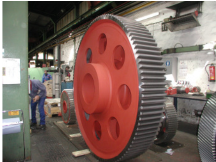
Geschweißtes Zahnrad vor der Einsatzhärtung, rote Bereiche vor dem Aufkohlen geschützt
