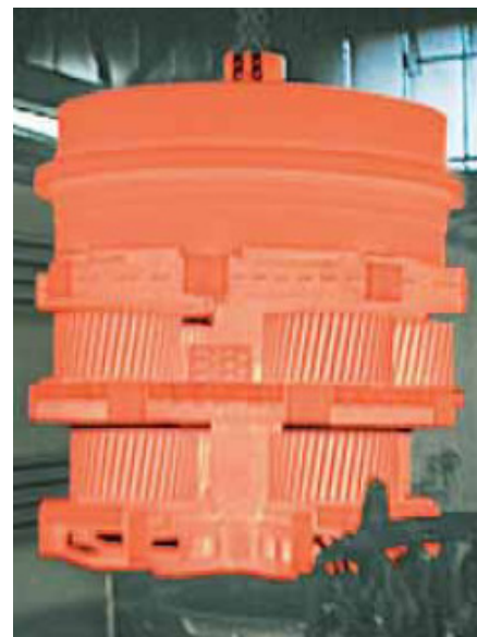
Einsatzhärtecharge 820 °C unmittelbar vor dem Eintauchen in ein Ölbad
