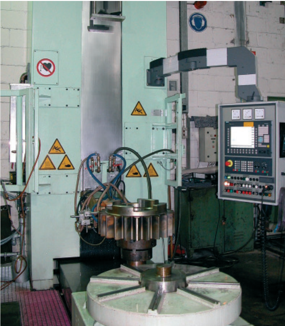
2: Versuchshärteanlage von SMS Elotherm
