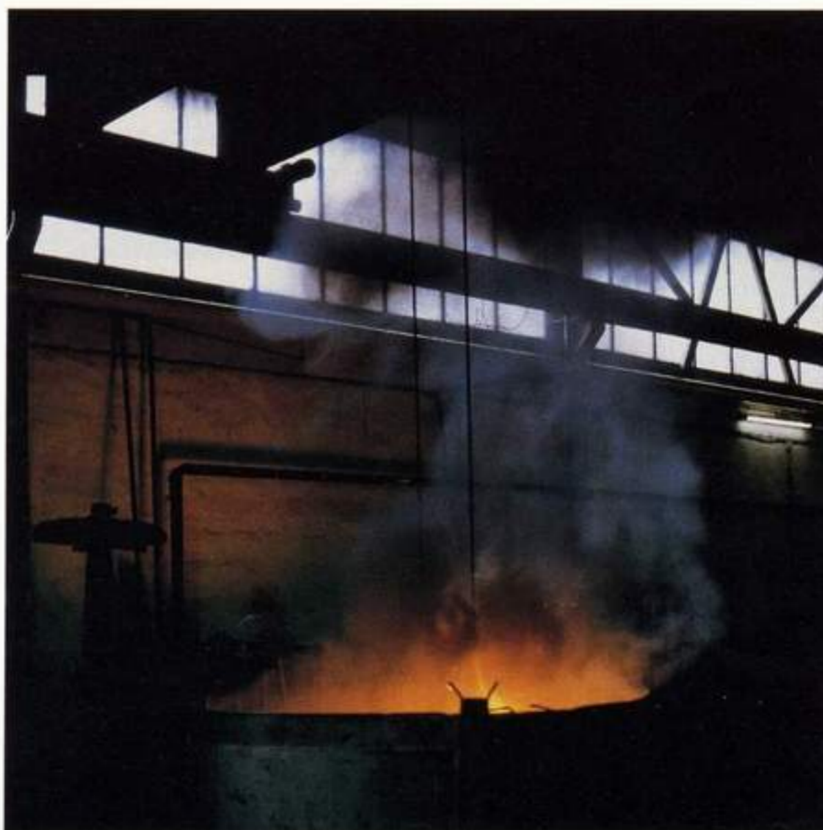
Von oben nach unten: Abschrecken von zwei Plungern bei etwa 860 °C in Öl (Bildnachweis: Härtereierochum)
