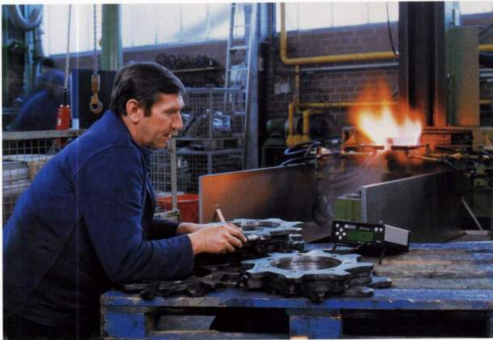
Die Werkstücke werden nach der Behandlung auf ihre erreichten Härtewerte hin überprüft
