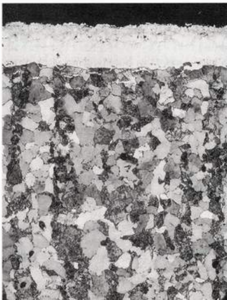
1: Typischer Aufbau einer Nitrierschicht Gefügeaufnahme (500:1) eines gasnitrierten Stahls C 45
