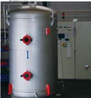
Einer der sechs Plasmaöfen am Standort Altlußheim bei Mannheim, dem Werk 2 der Härtereien Reese Brackenheim GmbH
