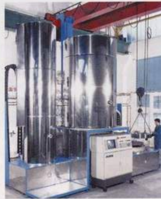
Beispielbild einer Plasma-Nitrieranlage. Eine wesentlich größere Anlage wird derzeit bei der Härterei Reese Bochum installiert.
