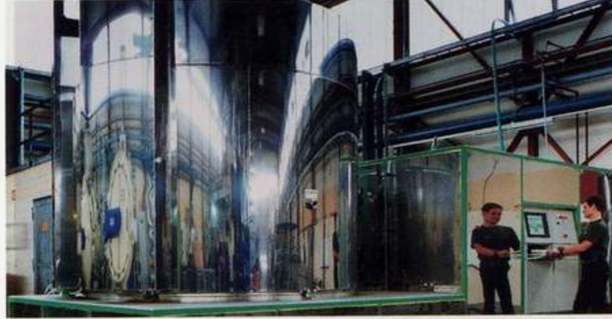
Die Plasma-Anlage: Nitrieren, Nitrocarburieren und Korrosionsschutz in einer neuen Dimension.
