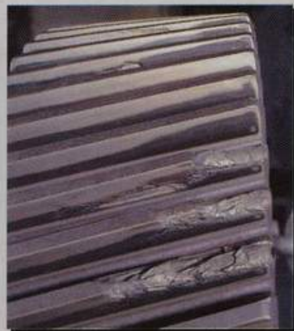
Die Schleifbrandprüfung macht die Ursache von Schäden sichtbar – Im Bild eine Schadensanalyse. Mit einer Prüfung im Vorfeld hätte man diesen Schaden vermeiden können.
